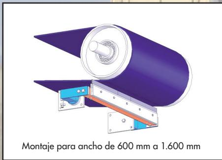
Montaje para ancho de 600 mm a 1.600 mm
