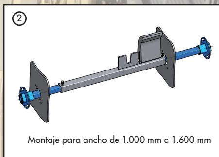
Montaje para ancho de 1.000 mm a 1.600 mm
