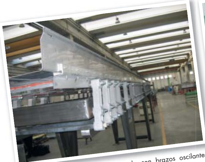
Transportador de dos masas para el transporte de material y equipado con brazos oscilantes dobles AD-P 50
