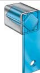
Fig. 18 Sección cuadrada interior de metal macizo y palanca soldada
