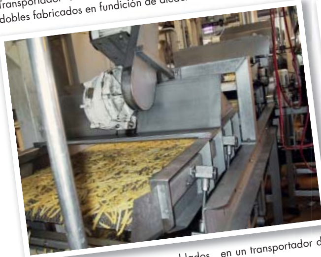
Transportador de una masa para el cribado, transporte y clasificación de virutas de madera
