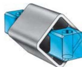
Fig. 16 Sección cuadrada interior de metal macizo y con taladros transversales en cada extremo
