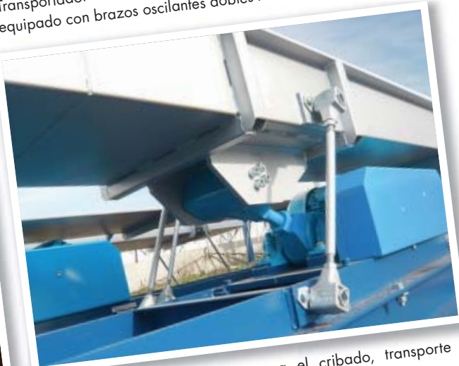
Transportador de dos masas equipado con brazos oscilantes dobles fabricados en fundición de aleación ligera
