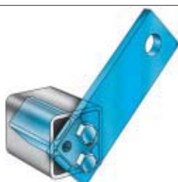
Fig. 17 Fijación con dos taladros pasantes y atornillado sobre la palanca
