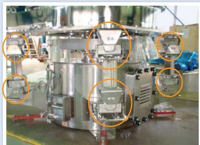
Tamiz giratorio equipado con 8 juntas universales del tipo AK-I 40 (fabricados en acero inoxidable)
